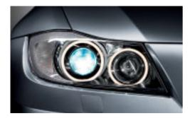
☐ Xenon-Licht für Abblend- und Fernlichtfunktion, inkl. vier Standlichtringen und automatischer Leuchtweitenregulierung, leuchtet die Fahrbahn nachts und bei schlechter Sicht deutlich besser aus.
