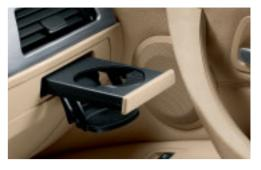
□ **Zwei Getränkehalter vorn,** (in Verbindung mit Ablagenpaket) in die Instrumententafel integriert.
