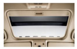
□ Glasdach, elektrisch, mit Schiebe- und Hebefunktion, Windabweisersowie Komfortöffnung über die Fernbedienung, inkl. Leseleuchten vorn und beleuchteten Make-up-Spiegeln.
