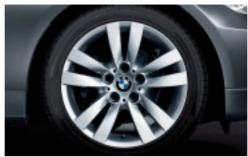
□ **BMW** Leichtmetallräder Doppelspeiche 161 mit Mischbereifung, vorn 8 J x 17 Zoll, Bereifung 225/45 R 17, hinten 8,5 J x 17 Zoll, Bereifung 245/40 R 17.
