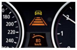
□ Aktive Geschwindigkeitsregelung ermöglicht das komfortable Fahren mit einer vorgewählten Geschwindigkeit. Bei Kolonnenfahrt passt sich Ihr BMW an ein langsamer vorausfahrendes Fahrzeug an und hält per Radarsensor automatisch einen vorgewählten Abstand ein. Zusätzlich stellt die Bremsfunktion sicher, dass auch bei Bergabfahrt die Wunschgeschwindigkeit konstant bleibt.
