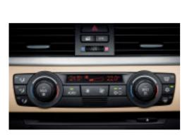
□ Klimaautomatik, inkl. AUC, Mikrofilter, Beschlag- und Solarsensor sowie Restwärmetaste, sorgt schnell für Ihr Wunschklima und hält eine vorgewählte Temperatur konstant. Mit Temperatureinstellung vorn (rechts/links getrennt) und temperiertem Ablagefach in der Mittelkonsole, inkl. Fond-Belüftung und -Klimatisierung.
