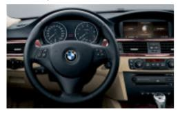
□ Sport-Lederlenkrad mit Multifunktion (Durchmesser 369 mm), drei Speichen, inkl. Schaltknauf mit Chromspange und Handbremshebelgriff in Leder, Multifunktion für Fernbedienung von Radio bzw. Telefon (beides optional); erhältlich auch ohne Multifunktion.
