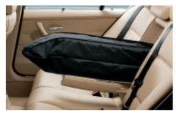
□ Skisack (in Verbindung mit Durchladesystem) ermöglicht den sauberen und sicheren Transport von bis zu vier Paar Ski bei gleichzeitig bis zu vier Personen im Fahrzeug; wird der Skisack nicht benötigt, ist er Platz sparend und nicht sichtbar verstaut.
